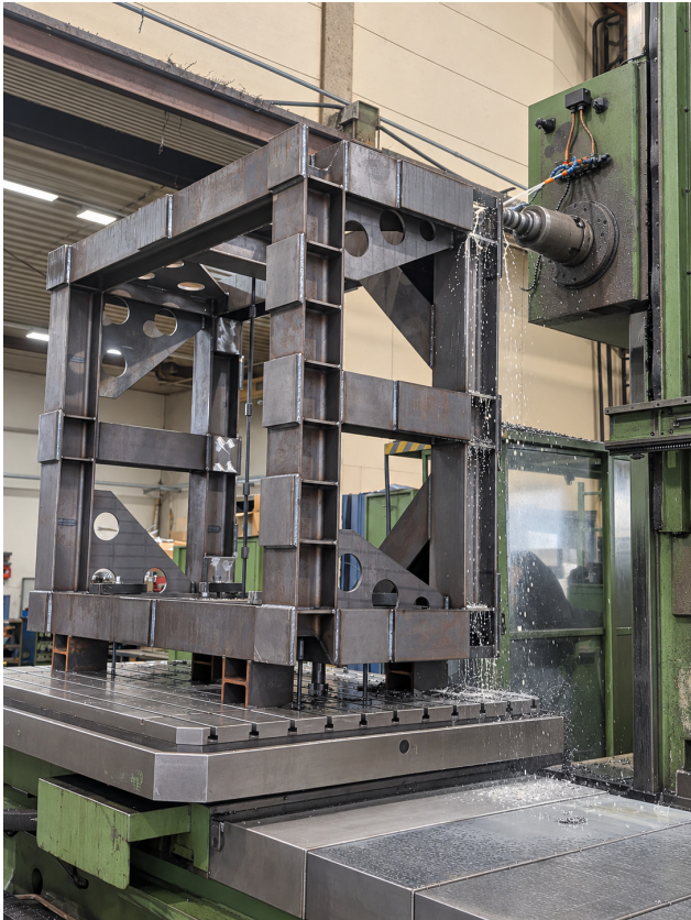
Schweißkonstruktion in der Bearbeitung
